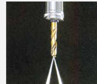
主軸貫穿冷卻裝置(不含刀具)
